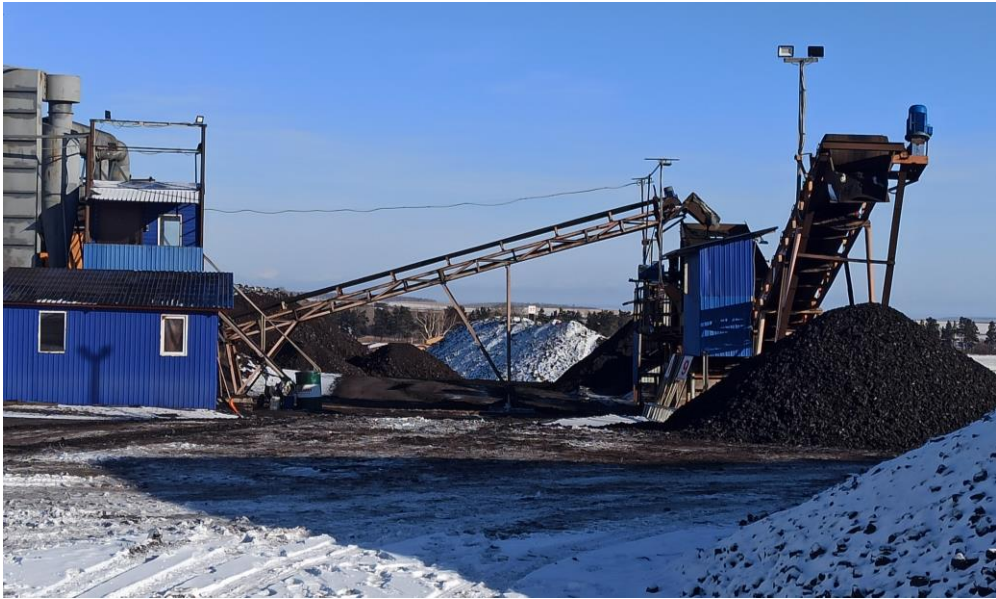
Рис. 3. Дробильная установка для подготовки угля к погрузке
