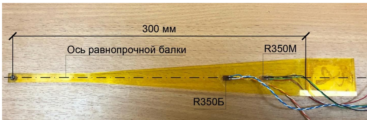
Рис. 1. Общий вид равнопрочной балки с наклеенными тензорезисторами
