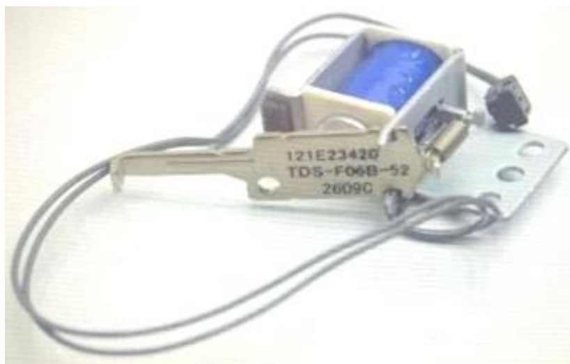
Рис. 9. Тормозной соленоид в виде электромагнита
