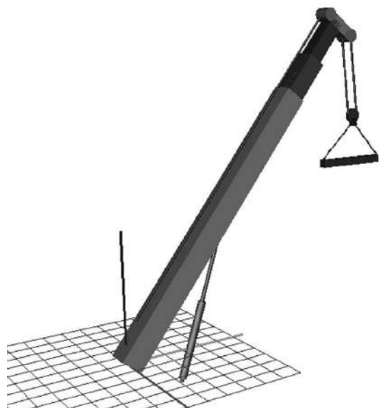
Рис. 1. Компьютерная модель трехсекционной телескопической стрелы
