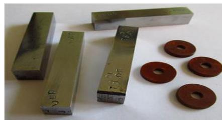
**Рис. 2. Образцы сталей для изготовления компенсационных датчиков**
