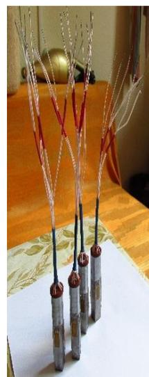
**Рис. 3. Изготовление компенсационных датчиков с применением тензорезисторов**
