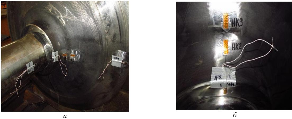
**Рис. 5.** Наклеивание тензорезисторных датчиков:
