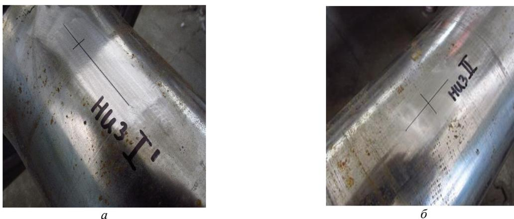
**Рис. 4.** Нанесение разметки под тензорезисторные датчики на элементах колесной пары:
