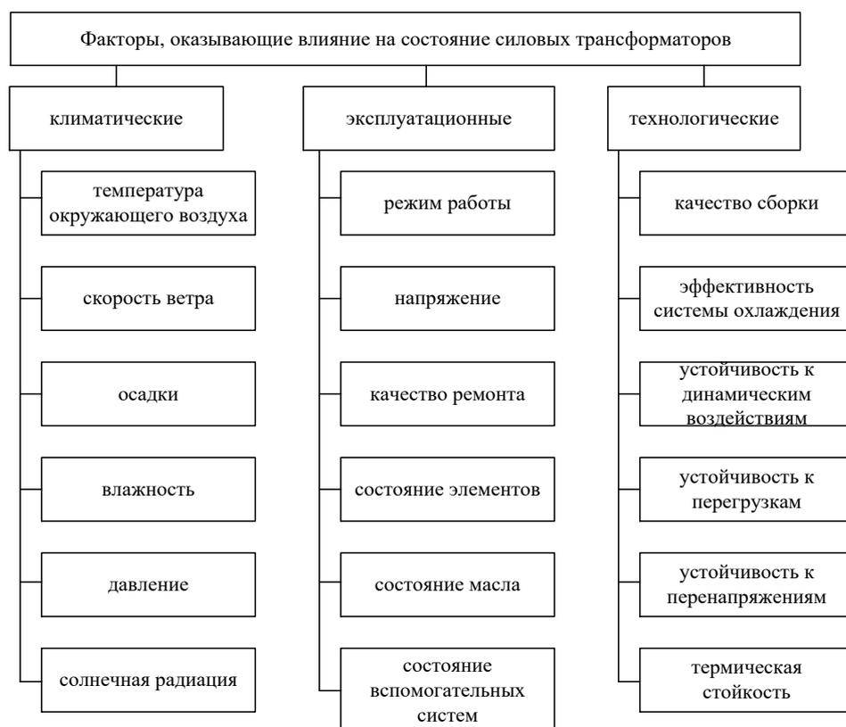
Рис. 1. Факторы, оказывающие влияние на состояние силового трансформатора
