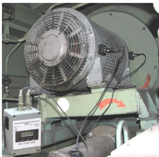
**Рис. 3.** Установка двухканального виброизмерительного блока и его датчиков вибрации на МВ2
