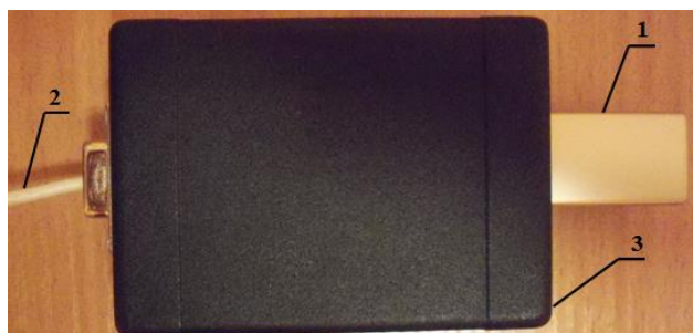
Рис. 2. Внешний вид блока датчика в корпусе: 1 – защитный колпачок чувствительного элемента; 2 – экранированный кабель; 3 – экранированный корпус
