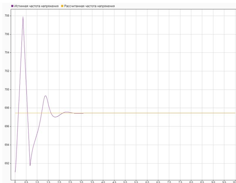
**Рис. 19.** Расчет частоты напряжения по опережению поля
