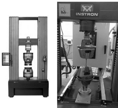
Рис. 8. Универсальная электромеханическая испытательная машина INSTRON 5982 Fig. 8. Universal electromechanical testing machine INSTRON 5982
