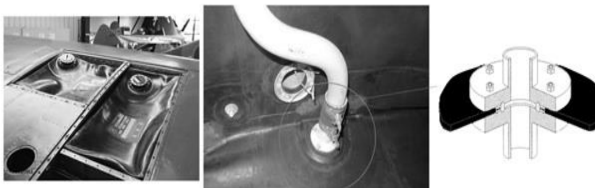
Рис. 1. Фланцевое соединение топливного бака самолета
