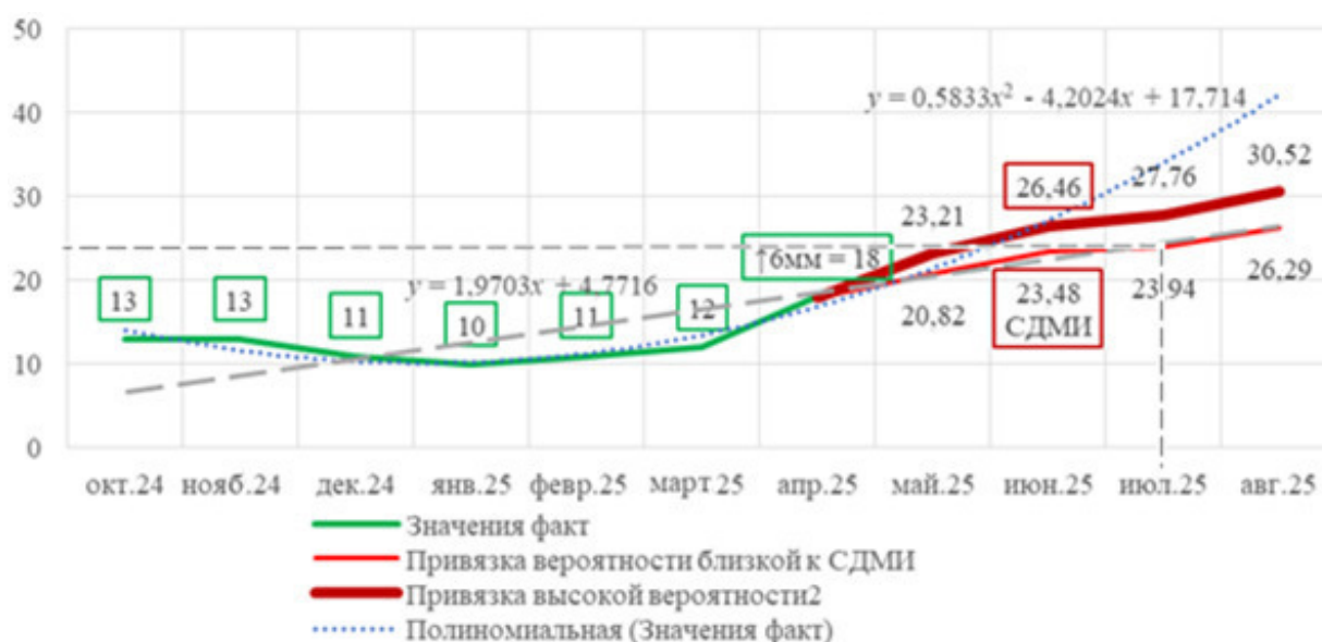
Рис. 6. Прогноз развития неисправности методом экспоненциального сглаживания высокой вероятности развития перекоса пути
