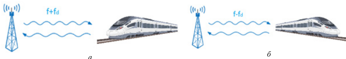
Рис. 1. Демонстрация эффекта Доплера ( f – исходная частота, f_d – частота, регистрируемая неподвижным приемником):
