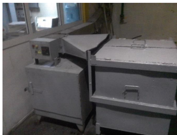
Рис. 3. Сушильный шкаф с индикаторным табло (слева) и ванна с лаком ФЛ-98 (справа)
