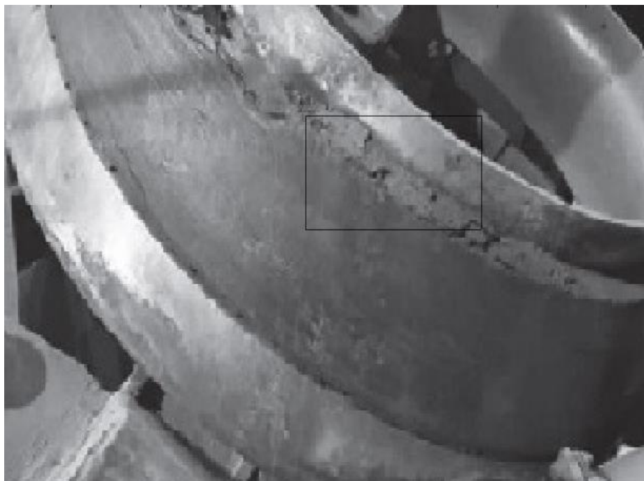
Рис. 1. Характерный износ футеровочной брони дробилок среднего и мелкого типов дробления Fig. 1. Typical wear of lining armor in medium and fine type crushers
