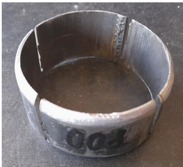
Рис. 7. Фотография детали, деформированной угловой шлифовальной машиной
