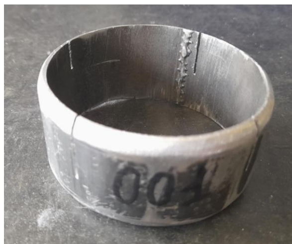
Рис. 6. Фотография детали, деформированной ножовкой по металлу Fig. 6. Photo of a hacksaw deformed part
