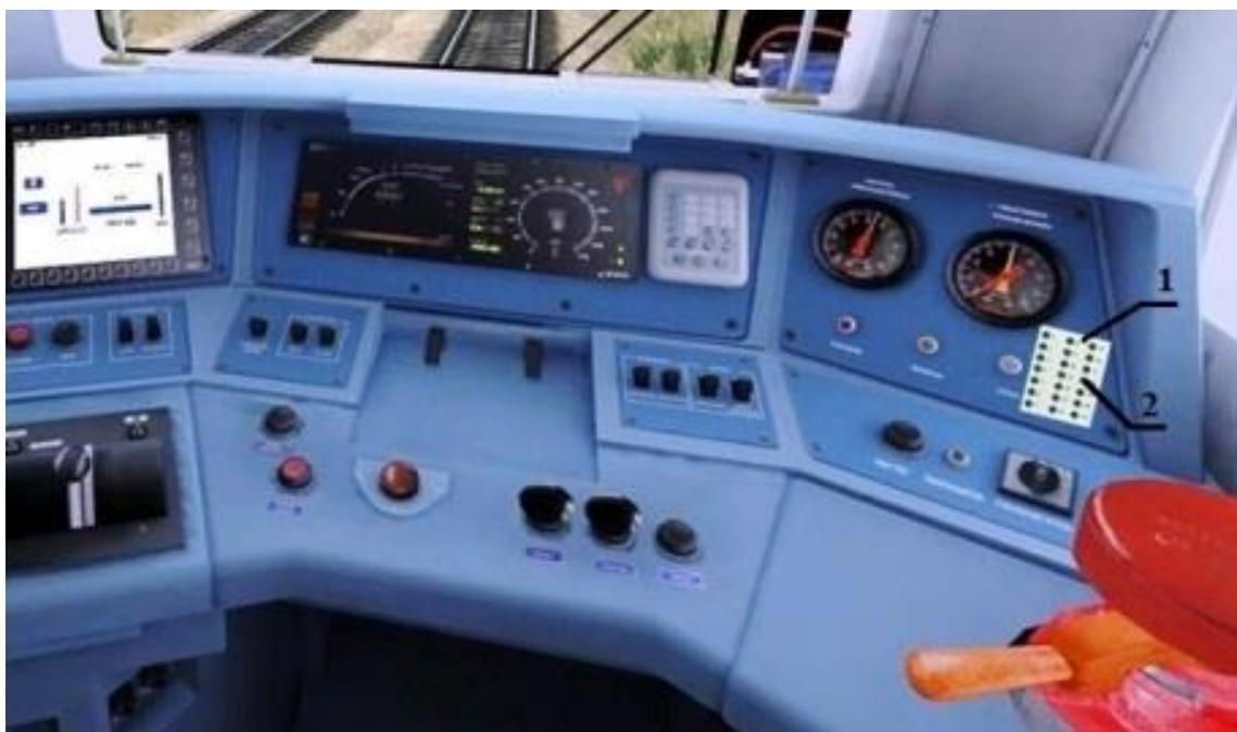
**Рис. 5.** Расположение приемного полукомплекта устройства диагностики электропневматических тормозов:
