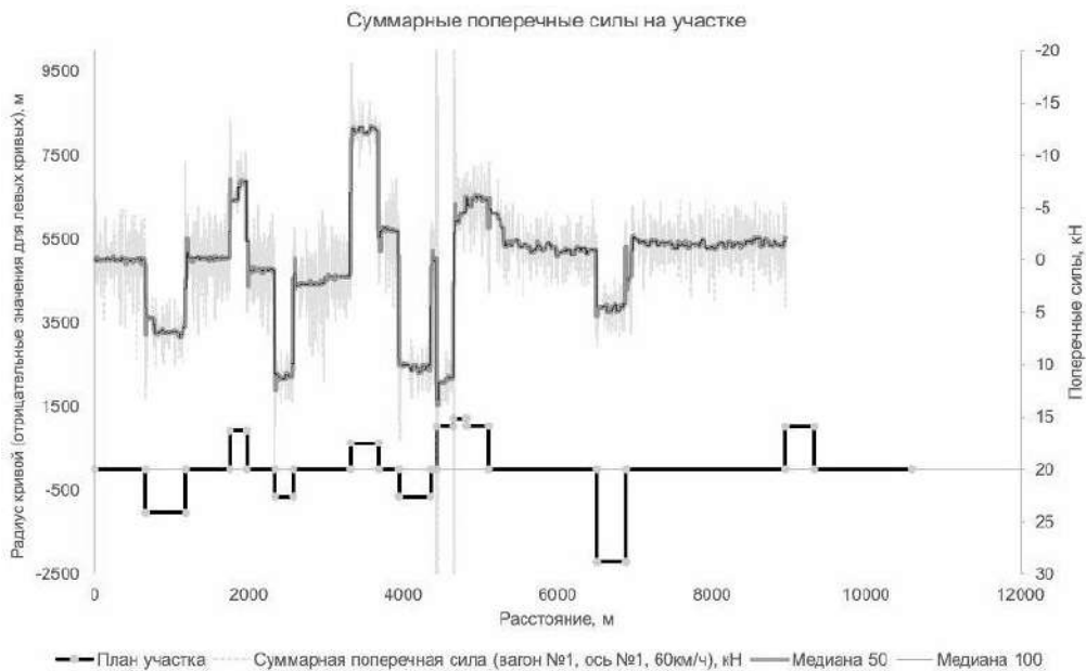
Рис. 3. Значения поперечных сил первого этапа эксперимента (проектный план)
