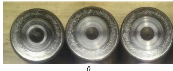
Рис. 8. Детали подшипников с дефектами, которые являются основными причинами отказов:
