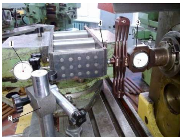
Рис. 7. Установка измерения жесткости приспособления:
