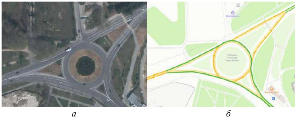
Рис. 4. Развязка на площади Комбата Неустроева, г. Севастополь: a – снимок со спутника; б – дорожная ситуация Fig. 4. Interchange at the Kombat Neustroev Square, Sevastopol: a – satellite image; b – traffic situation
