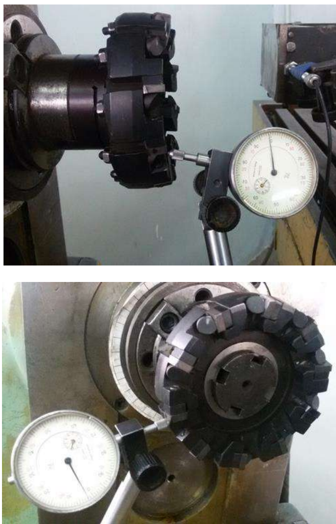
Рис. 3. Измерение радиального и торцевого биения зубьев Fig. 3 Measurement of radial and face runout of teeth
