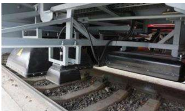
Рис. 1. Крепление антенных блоков под кузовом вагона
