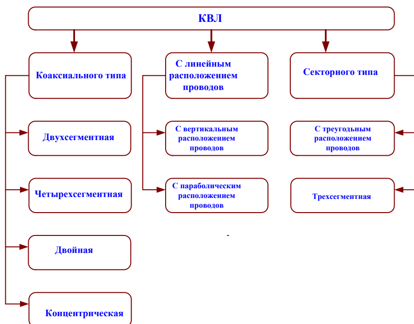
Рис. 4. Классификация компактных высоковольтных линий
