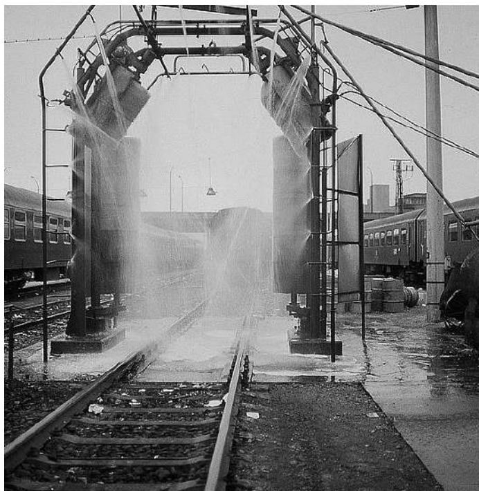
Рис. 3. Дезинфицирующие туннели, установленные перед железнодорожными станциями для обеззараживания поезда, прибывающего на железнодорожный вокзал
