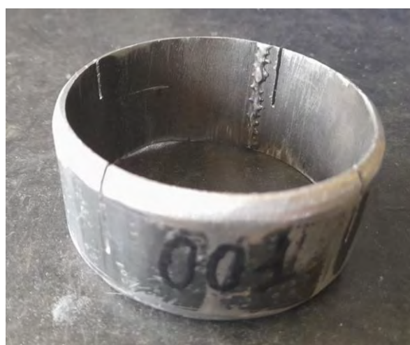
Рис. 6. Фотография детали, деформированной ножовкой по металлу Fig. 6. Photo of a hacksaw deformed part
