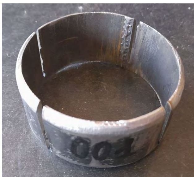
Рис. 7. Фотография детали, деформированной угловой шлифовальной машиной
