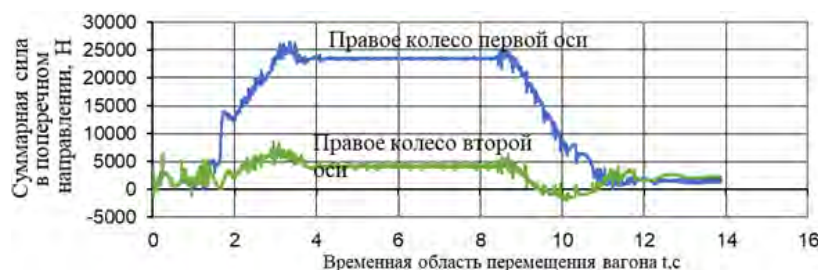
Рис. 2. График динамического движения вагонов в кривом участке пути Fig. 2. Graph of the dynamic movement of wagons in a curved section of the track
