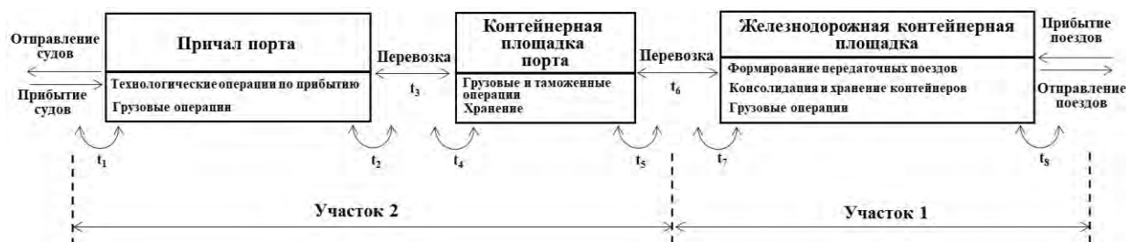
Рис. 4. Технологическая схема работы Пусанского транспортного узла:
