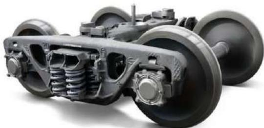
Рис. 1. Тележка модели 18-100М
