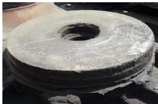
Рис. 8. Пятник с изношенными контактными поверхностями
