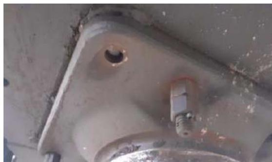
Рис. 9. Обрыв крепежного болта пятника
