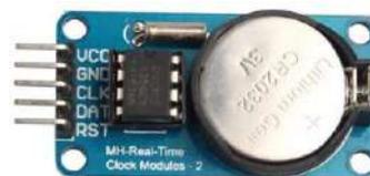
**Рис. 9.** Энергонезависимые часы
