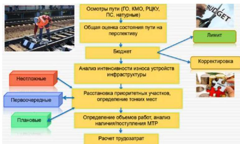
Рис. 1. Схема планирования работ по текущему содержанию пути
