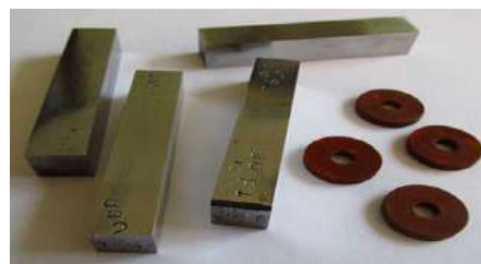
Рис. 2. Образцы сталей для изготовления компенсационных датчиков
