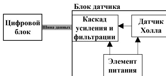
Рис. 1. Структурная схема прибора регистрации напряженности и индукции магнитного поля Fig. 1. Block diagram of the device for registering the intensity and induction of the magnetic field
