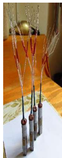
Рис. 3. Изготовление компенсационных датчиков с применением тензорезисторов
