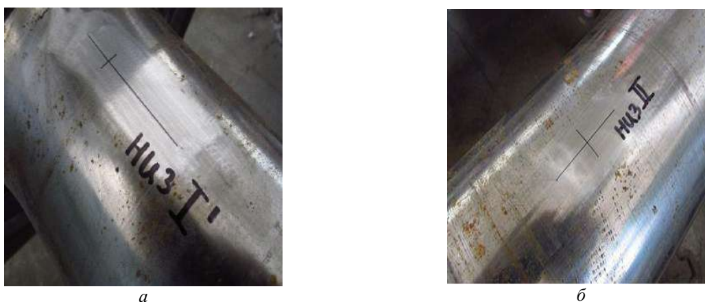
Рис. 4. Нанесение разметки под тензорезисторные датчики на элементах колесной пары: a – правая нижняя часть оси; б – середина оси
