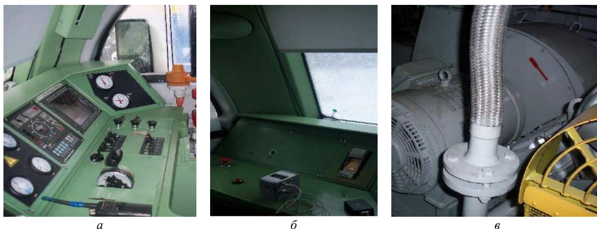
Рис. 5. Зоны измерения магнитного поля в локомотиве ЭП1П-065: а – зона машиниста; б – зона помощника машиниста, в – зона вспомогательных машин
