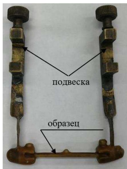
**Рис. 7.** Исследуемый образец, закрепленный на подвеске
