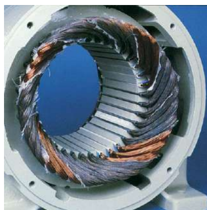
Рис. 6. Обрыв фазы Fig. 6. Phase loss
