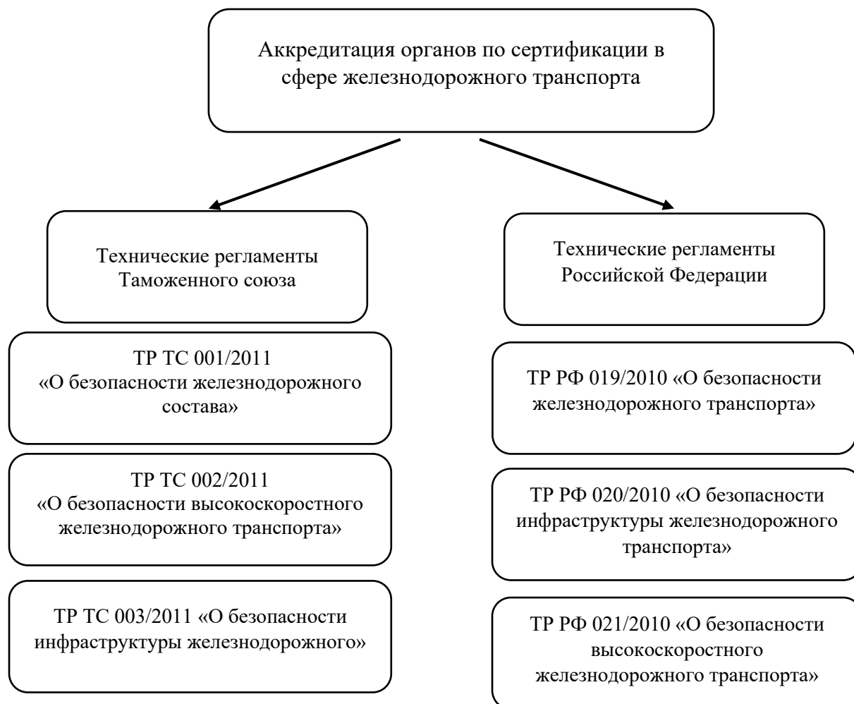
Рисунок 1 – Виды аккредитации органов по сертификации согласно установленным техническим регламентам Таможенного Союза и Российской Федерации в сфере железнодорожного транспорта
