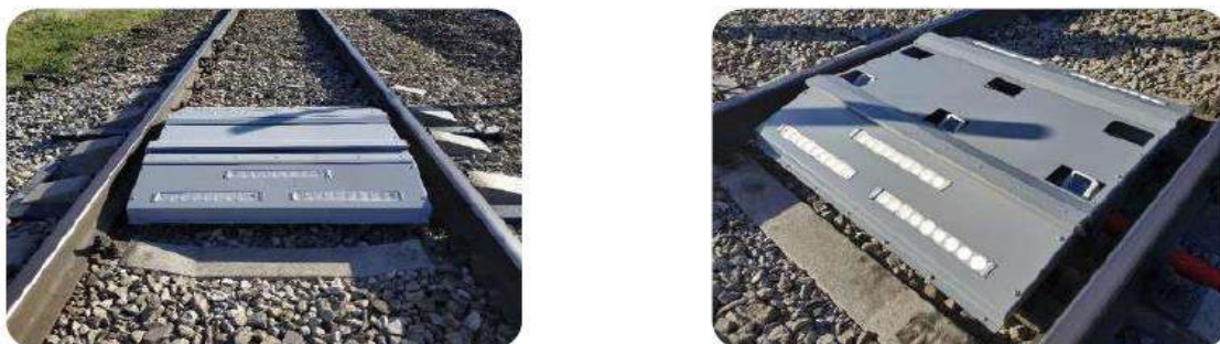
Рис. 3. Пример напольного оборудования (как аналога или замены датчиков) для сбора данных о техническом состоянии вагона в реальном времени
