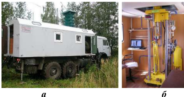
Рисунок 2. Установка статического зондирования УСЗ: а – внешний вид машины; б – внутренний вид лаборатории
