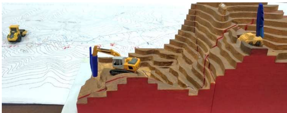
Рисунок 1. Фото макета местности и топографической карты с планом варианта трассы и размещением в точках зондирования грунтов моделей установок
