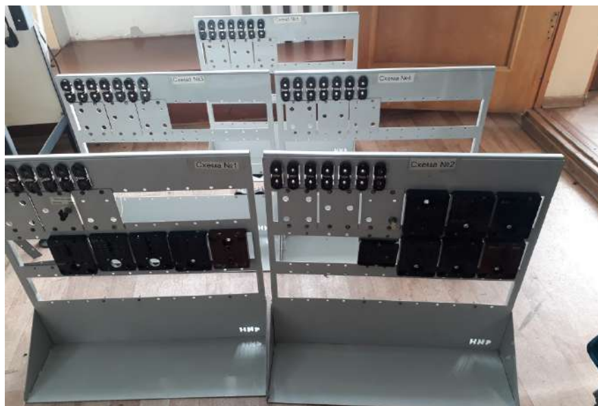
Рисунок 2. Релейные стивы и элементная база для выполнения пяти индивидуальных практических заданий
