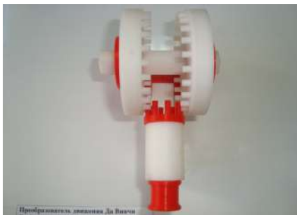
Рисунок 1 – Механизм «Преобразователь движения Да Винчи»
