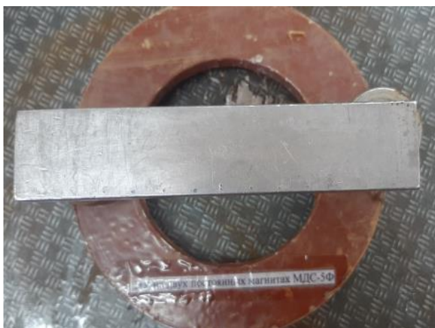
Рис. 1. Дефектное изделие перед проведением магнитопорошкового контроля
