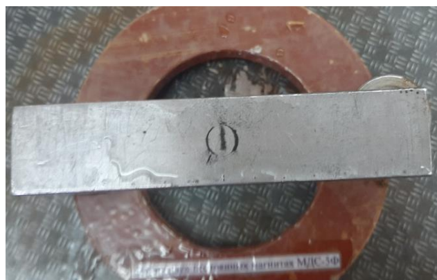
Рис. 2. Изделие после проведения магнитопорошкового контроля
