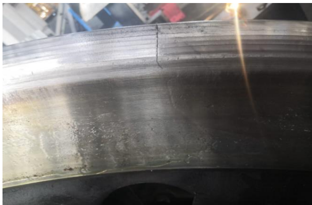
Рис. 3. Трещина гребня бандажа колесной пары
