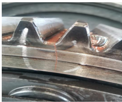
Рис. 4. Трещина зубчатого колеса
