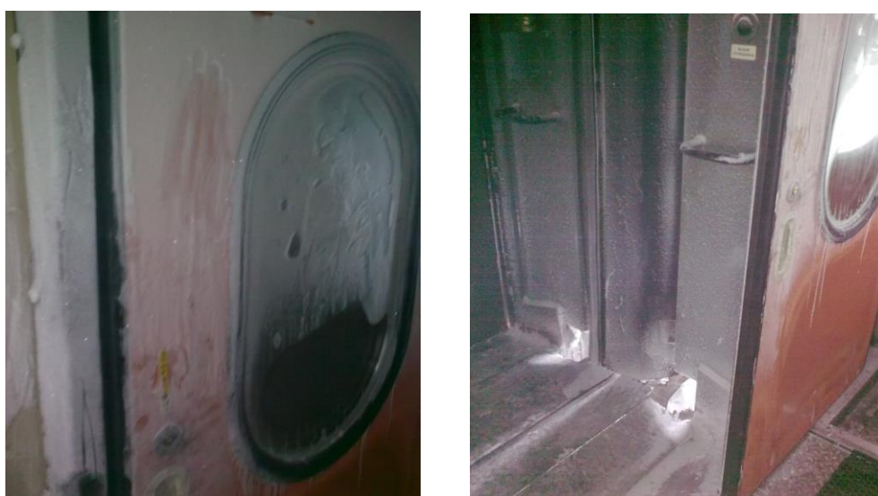
Рис. 2. Замерзание тамбурных дверей в зимний период (фото Пахомова С.В., фирменный поезд Иркутск-Забайкальск «Даурия», декабрь 2020 г.)
