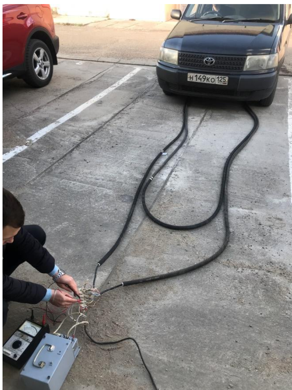
Рисунок 11 – Датчик ИПД, фиксация автотранспортного средства, шлейф 2 витка, выходное напряжение 0 В
