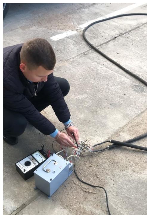
Рисунок 12 – Датчик ИПД, отсутствие автотранспортного средства, шлейф 1 виток в виде восьмерки, выходное напряжение 24 В
