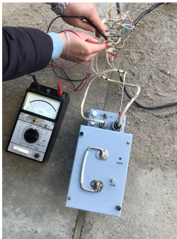
Рисунок 11 – Датчик ИПД, фиксация автотранспортного средства, шлейф 2 витка, выходное напряжение 0 В
