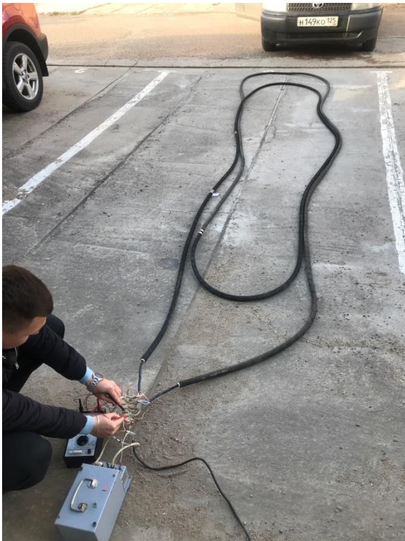
Рисунок 10 – Датчик ИПД, отсутствие автотранспортного средства, шлейф 2 витка, выходное напряжение 24 В
