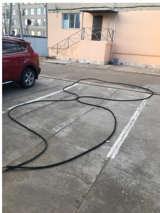
Рисунок 12 – Датчик ИПД, отсутствие автотранспортного средства, шлейф 1 виток в виде восьмерки, выходное напряжение 24 В
