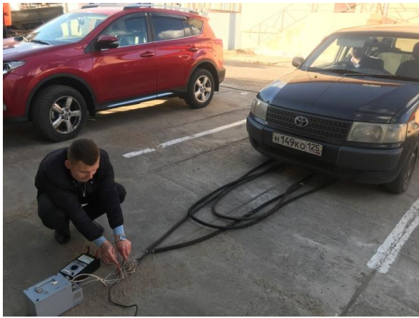
Рисунок 9 – Датчик ИПД, фиксация автотранспортного средства, шлейф 3 витка, выходное напряжение 0 В
