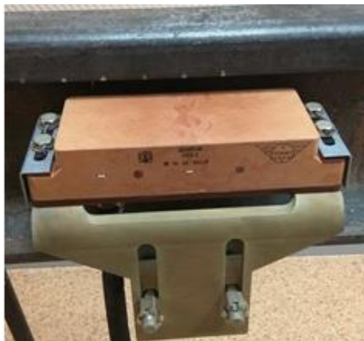
Рис. 6. Внешний вид датчика ДПЭП-М в лабораторных условиях
