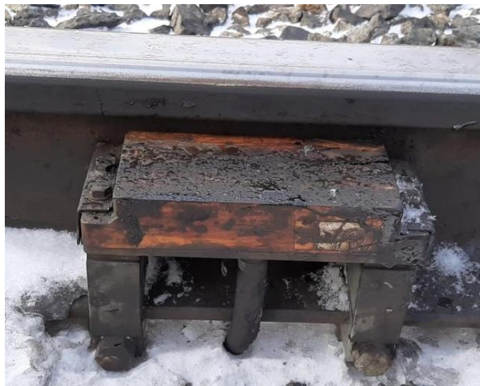
Рис. 9. Путевой датчик типа ДПЭП-М при эксплуатации
