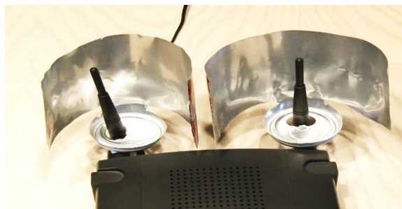
Рис. 3. Пример изготовления рефлекторов из алюминиевой фольги
