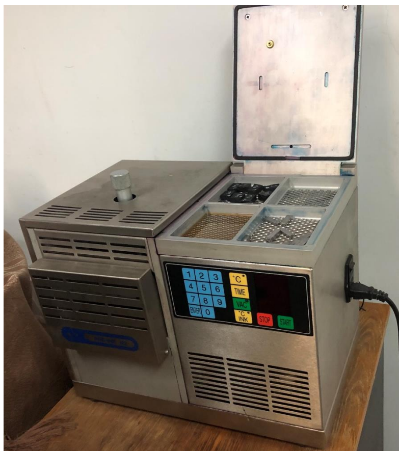
Рис. 3. Разработанная авторами автоматизированная установка экспресс-анализа резиновых и полимерных уплотнений
