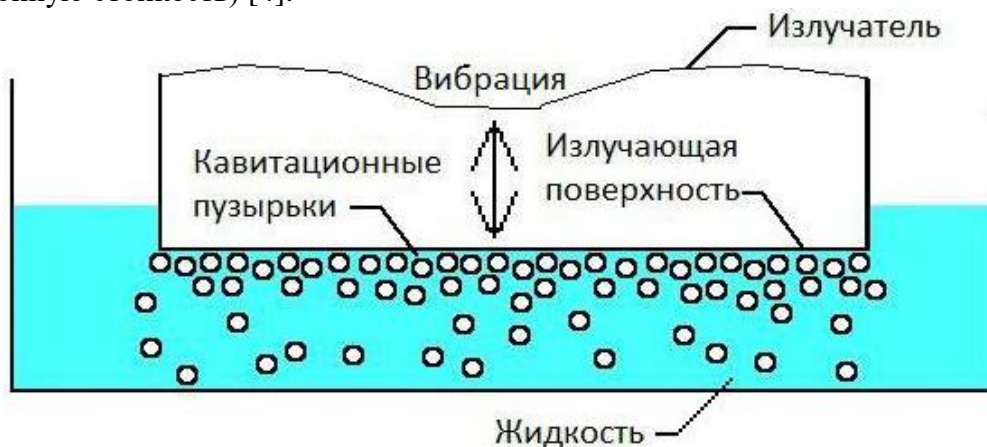
Рис. 1 Схема ультразвуковой очистки
