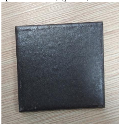
Рис. 1 Металлическая пластинка, покрытая Цинотаном и Ферротаном
