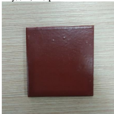
Рис. 2 Металлическая пластинка, покрытая Инвако Zn и Инвако 75
