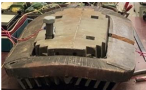
Рис. 1. Обмотка главного полюса тягового электродвигателя ЭДП-810
