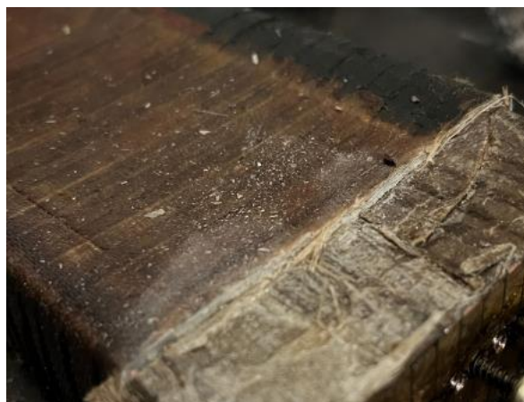
Рис.4. Разрез изоляции после пропитки
