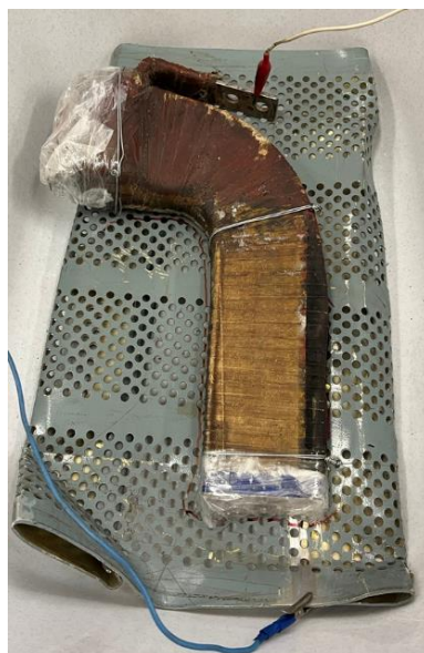
Рис.2. Подключенная обмотка с металлической пластиной
