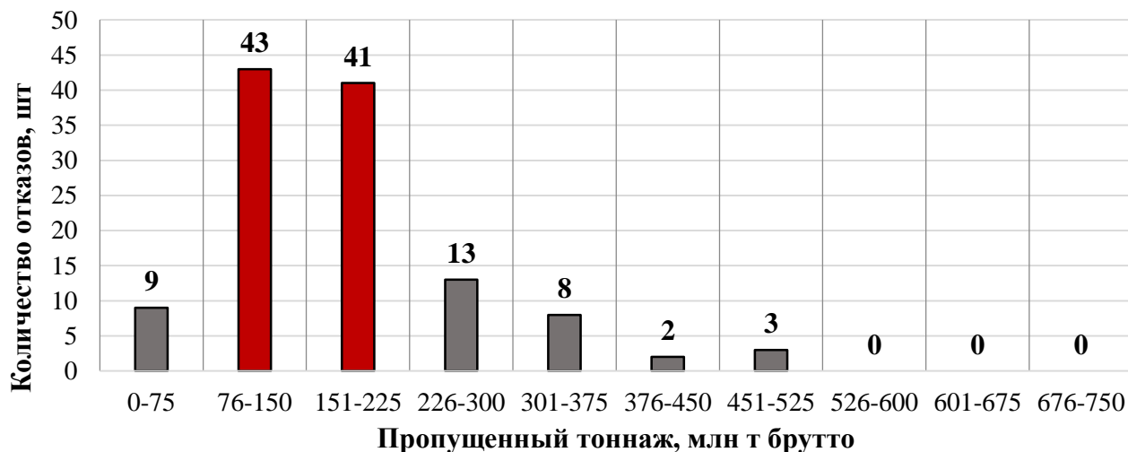
Рис. 1.4. Распределение наработки до отказа крестовинной части стрелочных переводов за период с 2020 по 2022 гг.
