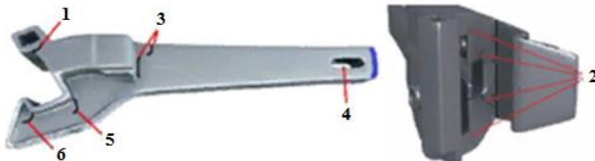
Рис.3. Зоны повреждения корпуса автосцепки
