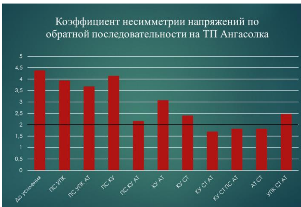
Рис.7 – Коэффициент несимметрии напряжений по обратной последовательности на ТП Ангасолка по результатам моделирования комбинированных способов усиления участка
