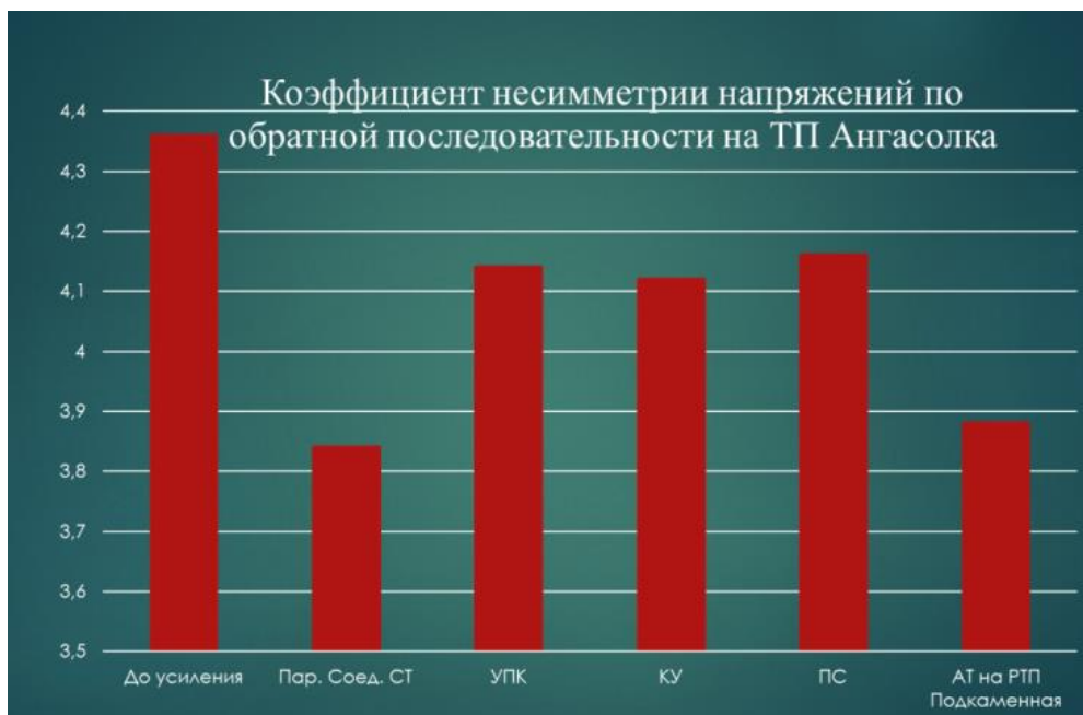
Рис. 4 – Коэффициент несимметрии напряжений по обратной последовательности на ТП Ангасолка по результатам моделирования индивидуальных способов усиления участка
