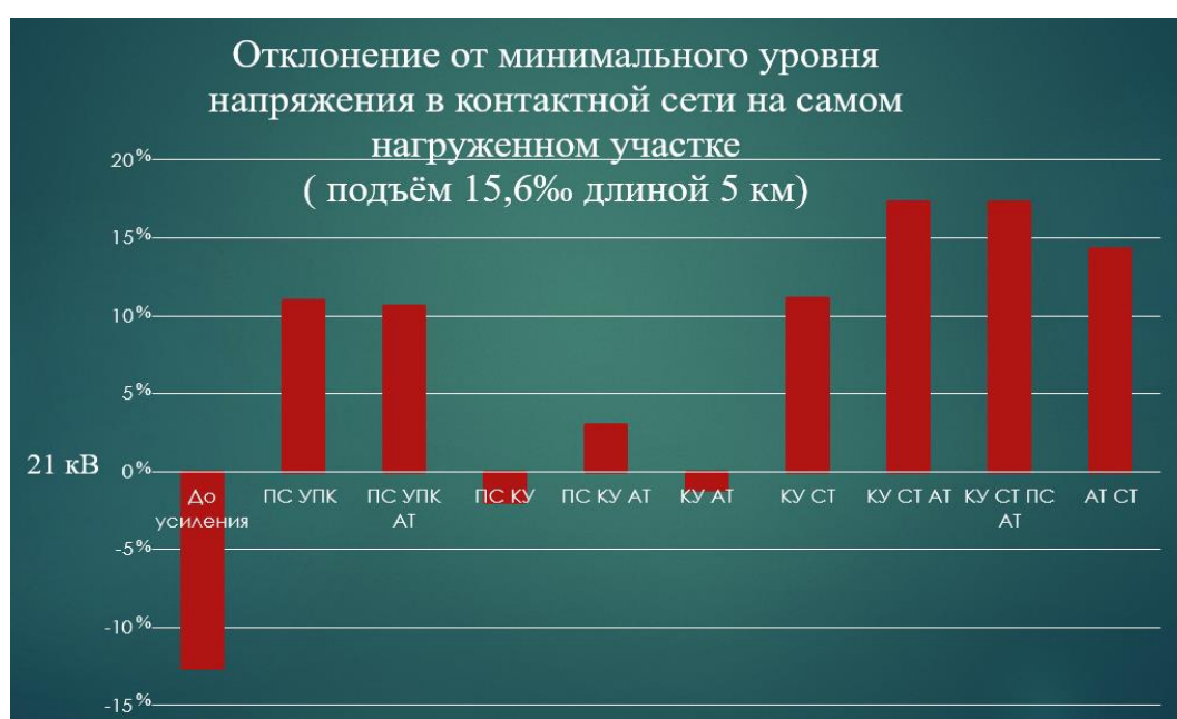
Рис. 5 – Отклонение от минимального уровня напряжения в контактной сети по результатам моделирования комбинированных способов усиления участка
