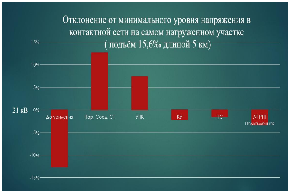
Рис. 2 – Отклонение от минимального уровня напряжения в контактной сети по результатам моделирования индивидуальных способов усиления участка
