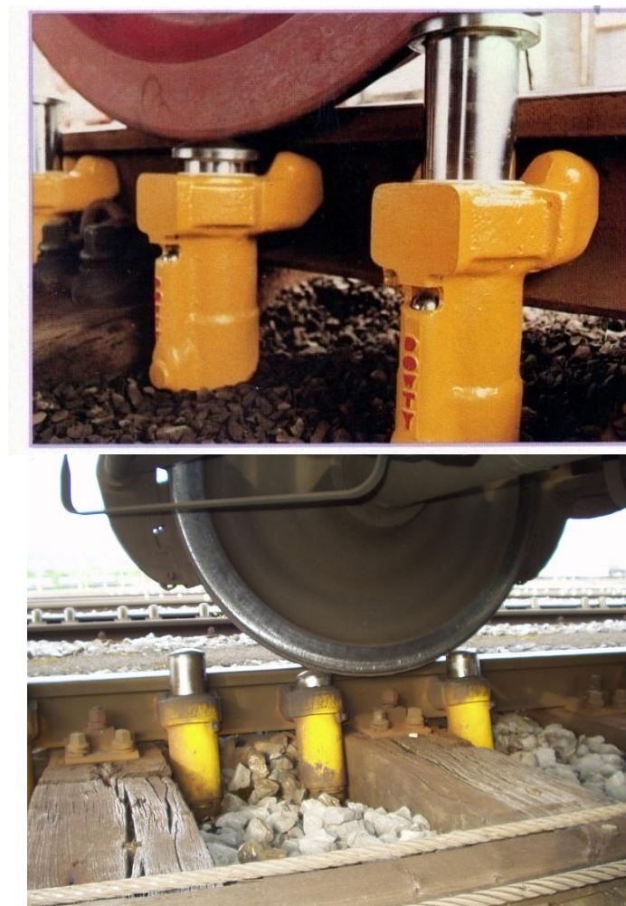
Рис. 2. Взаимодействие точечного замедлителя с гребнем колеса
