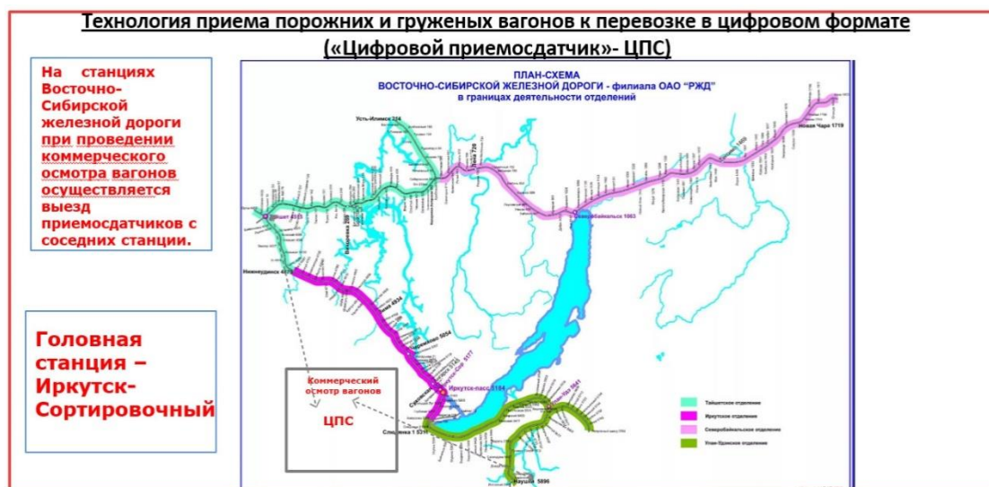
Рис.1. Схема Восточно-Сибирской железной дороги с возможным расположением системы «Цифровой приемосдатчик»
