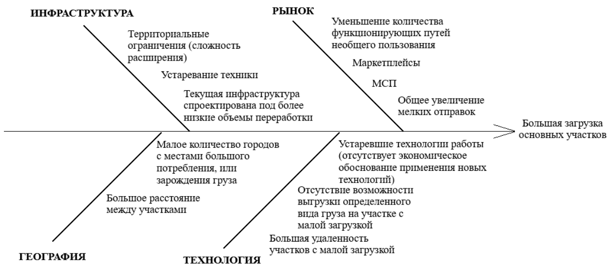
Рис. 3. Диаграмма проблем приводящих к большой загрузке основных участков МЧ ДВЖД
