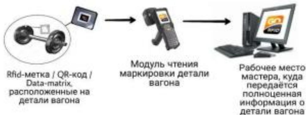
Рис. 9. Концепция взаимодействия метки с системой
