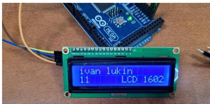
Рис. 4. ЖК дисплей LCD 1602 с I2C модулем
