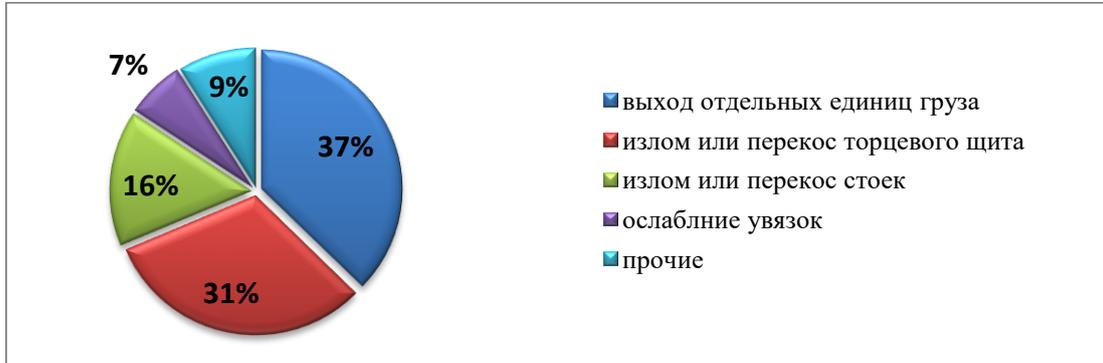
Рис. 1. Причины основных факторов, влияющих на отцепки вагонов с коммерческими неисправностями в пути следования груза
