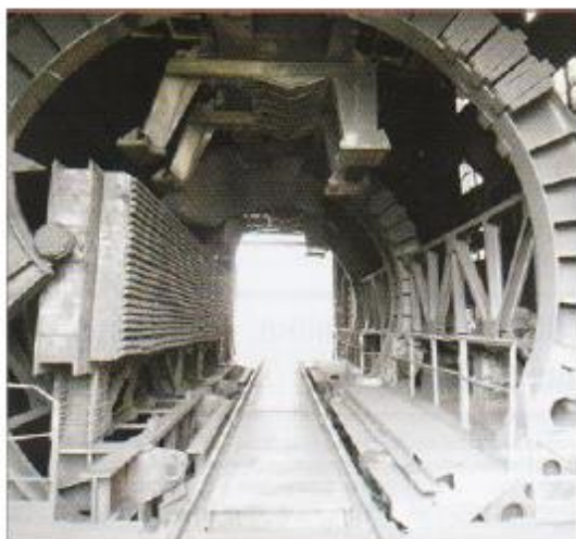
Рис. 7. Общий вид и схема вагонопрокидывателя
