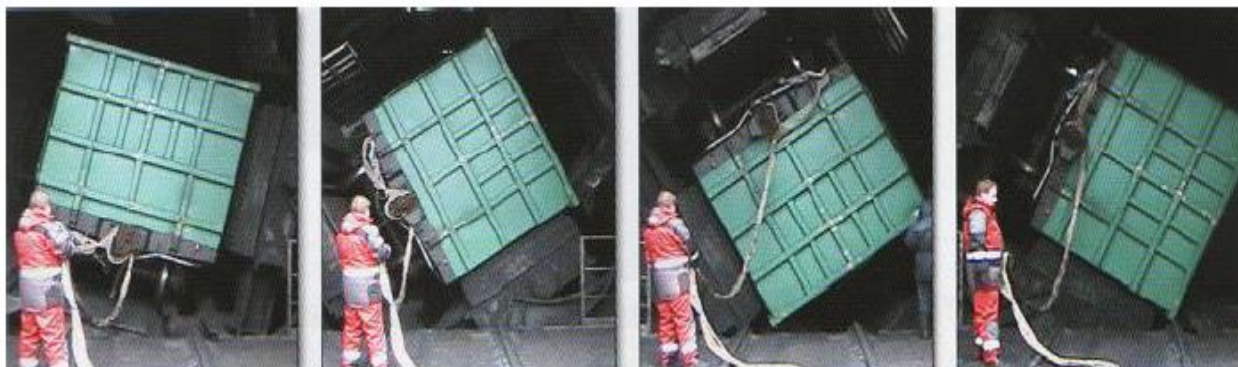
Рис. 8. Основные этапы поворота на вагонопрокидывателе
