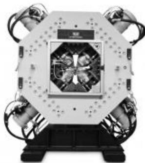
**Рис. 7. Двухосная испытательная машина**
