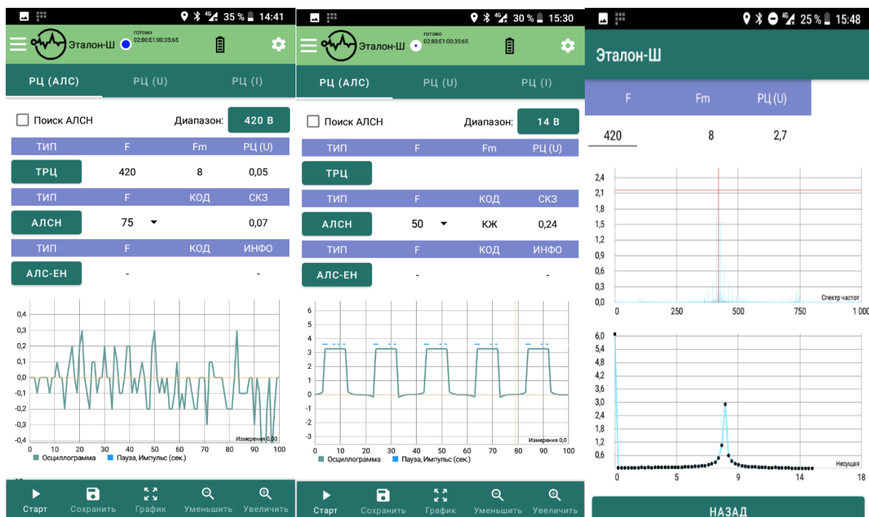
Рис.2. Отображение измерений прибором Эталон-Ш на экране МРМ-Ш
