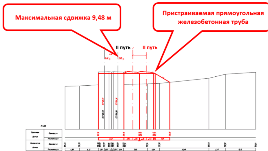
Рис. 2. Поперечник переустройства моста
